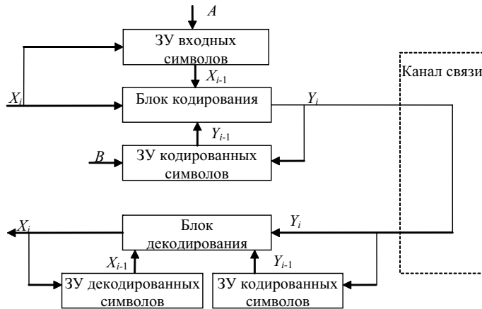
Рис. 3. Функциональная схема устройства рекуррентного кодирования и декодирования информации
